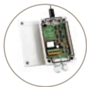
UNV MOTTAKER - 8002E 2-kanals mottaker. RF-modul 433 Mhz må bestilles separat. (801221). Kan programere 15 koder på hver kanal. 13 med fast koder eller rullerende koder, 1 dip switch kode og 1 nøkkelfritt åpningsystem.
