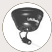
PARKERINGSSENSOR - 975RML Parkerings sensoren gjør det enklere å parkere bilen på riktig sted hver gang. En laserstråle lyser på bilens dashboard når bilen passerer en fotocelle. Laserstrålen er svært enkel å se. Enkel installasjon.
